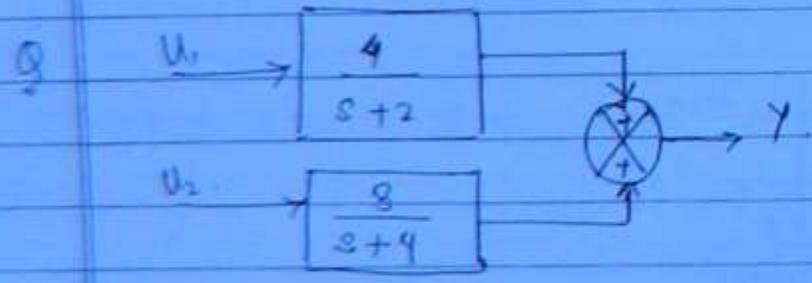
$$\begin{bmatrix} \dot{x}_1 \\ \dot{x}_2 \end{bmatrix} = \begin{bmatrix} -2 & 0 \\ 0 & -4 \end{bmatrix} \begin{bmatrix} x_1 \\ x_2 \end{bmatrix} + \begin{bmatrix} 1 & 0 \\ 0 & 1 \end{bmatrix} \begin{bmatrix} u_1 \\ u_2 \end{bmatrix}$$
