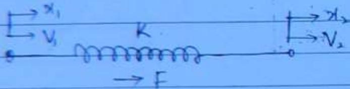
$$F = k \int (v_1 - v_2) dt = k \int v dt$$
