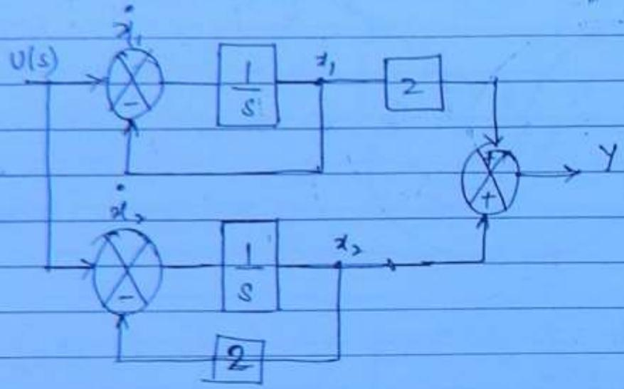
$$\begin{bmatrix} \dot{x}_1 \\ \dot{x}_2 \end{bmatrix} = \begin{bmatrix} -1 & 0 \\ 0 & -2 \end{bmatrix} \begin{bmatrix} x_1 \\ x_2 \end{bmatrix} + \begin{bmatrix} 1 \\ 1 \end{bmatrix} u$$
